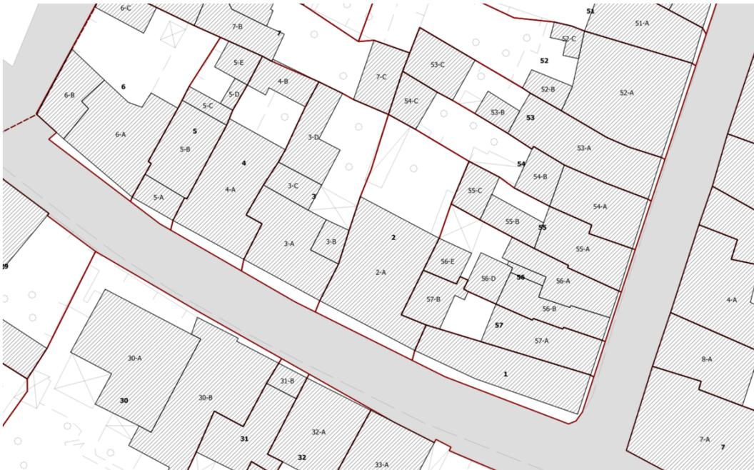
Figura 19: Stralcio della planimetria generale del Piano con l'individuazione delle Unità Edilizie interne agli isolati e la definizione delle Componenti Elementari
